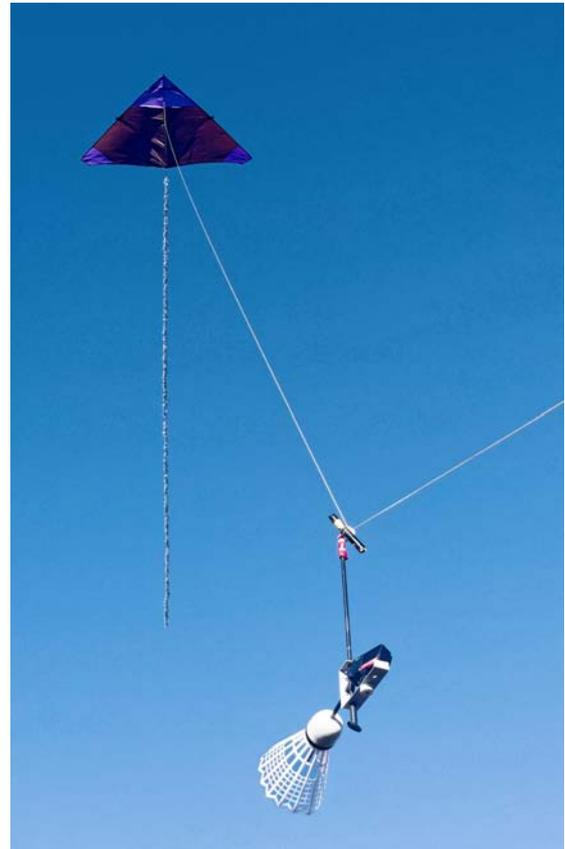
Photo 3 : Nacelle stabilisée par le volant de badminton XXL
