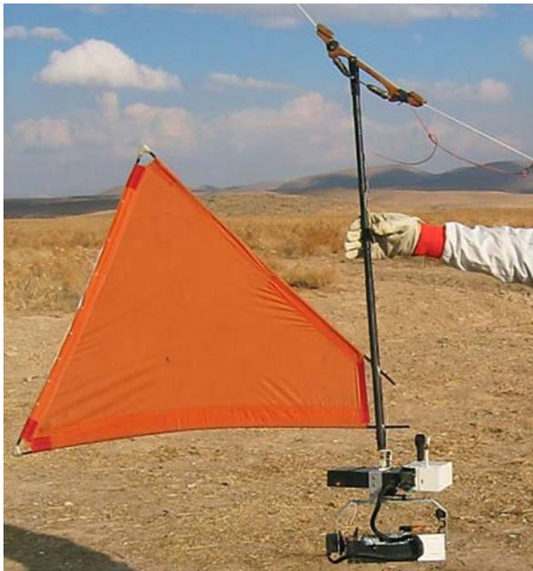
Pendule long avec amortissement dans les 2 axes
